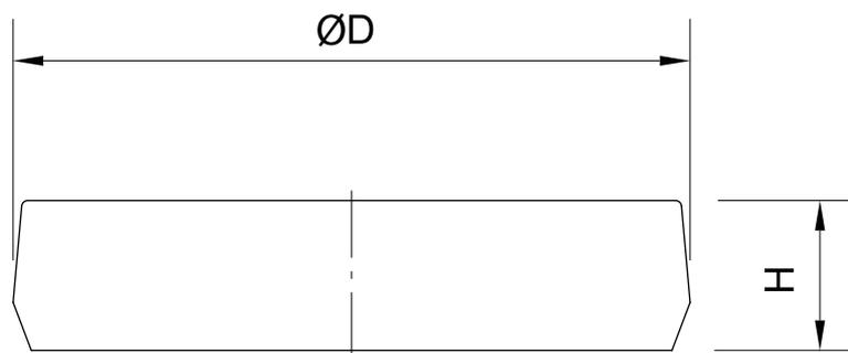
**Tabela 2-9-20: Dimensões das Tampas de Parafuso para Furos de Montagem do Trilho**
